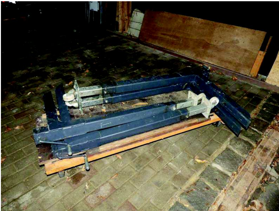
Abstützungen des Salzstreuers für die Demontage im Sommer
