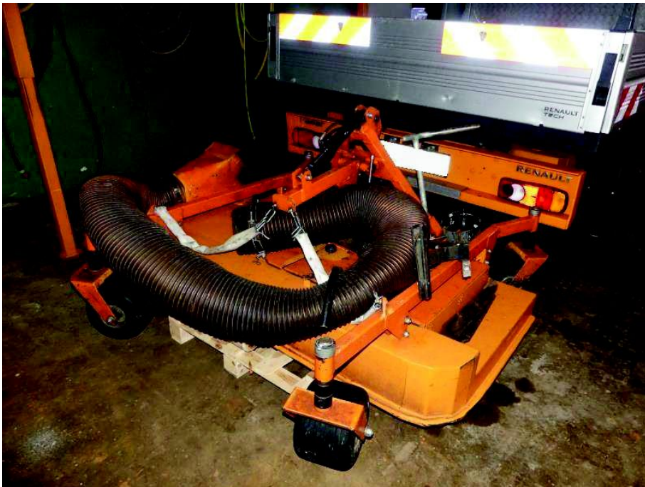
Mäheinrichtung mit Absaugung
