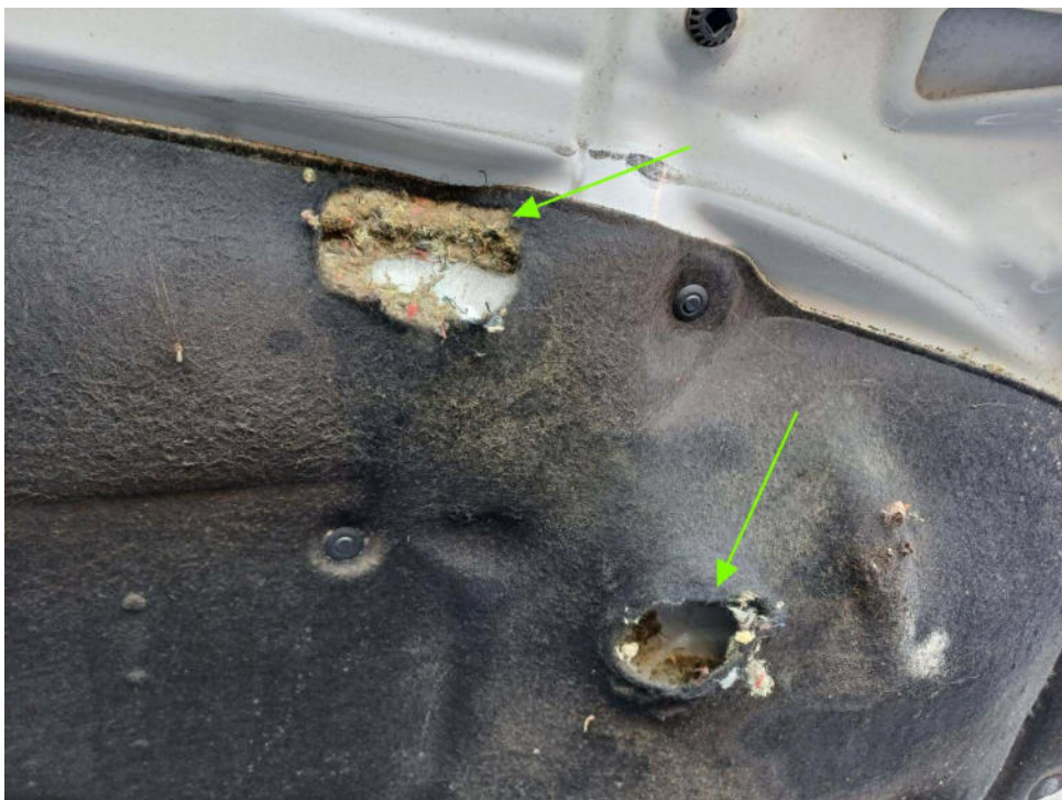
Bild 20 : Motorhaube Dämmung Tierversiss
