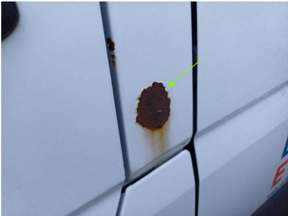
Bild 8 : B-Säule links stark angerostet
