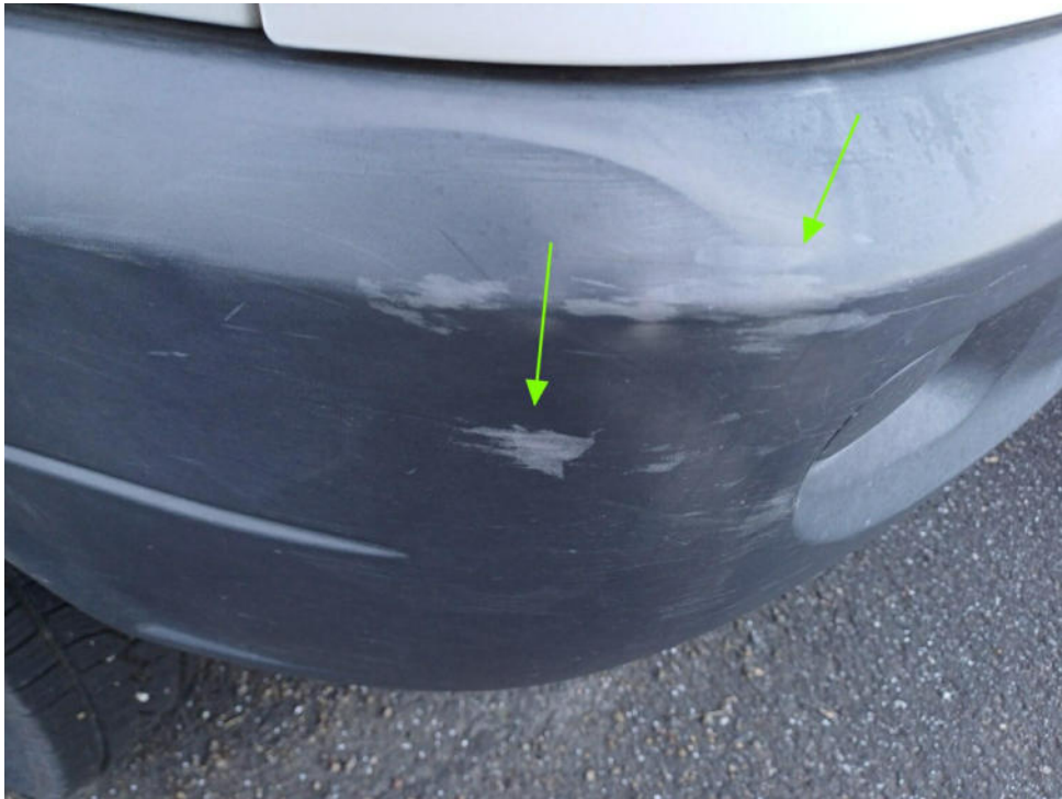
Bild 13 : Stoßfänger vorne zerkratzt
