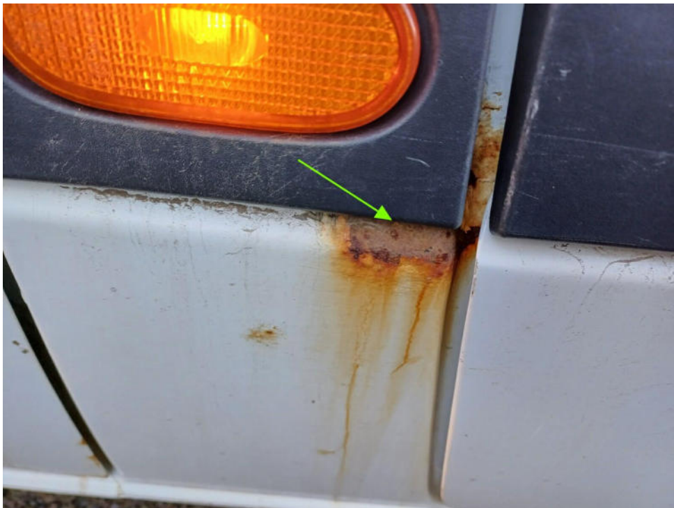
Bild 16 : B-Säule rechts stark angerostet
