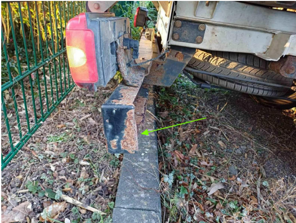
Bild 19 : Unterfahrschutz hinten verformt
