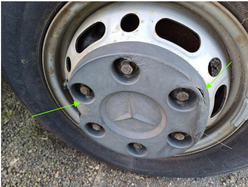
Bild 14 : Radzierring rechts gebrochen
