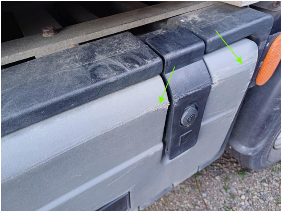
Bild 11 : Staukiste links, Klappe zerkratzt
