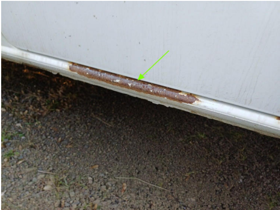
Bild 15 : Schweller rechts stark angerostet
