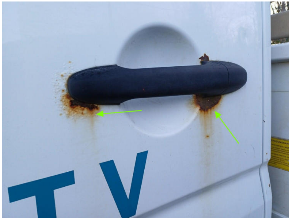
Bild 9 : Tür hinten links stark angerostet
